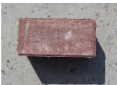
Поверхность камня до обработки гидрофобизатором
