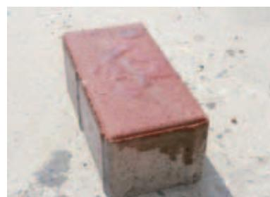
Поверхность камня после обработки гидрофобизатором
